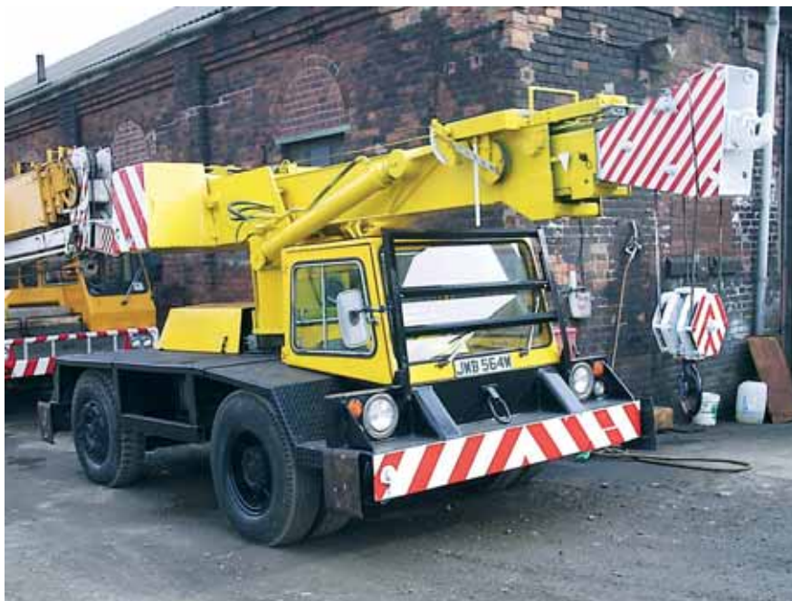
Figur 1.1.9: Her ser vi en ti tonns Hydra av typen Lorry Mounted Hydraulic fra 1966, betegnet Diesel Hydraulic, Wheel Base – 4 x 2. Foto: Shires Crane Hire
