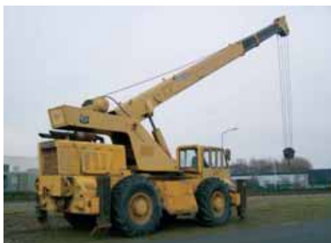
Figur 1.1.10: Her ser vi øverst en annonse av Grove RT60 fra Jøsang Kranutleie i Rogaland fra 1972. Det var ei 18-tonns kran, bygget etter terrengkrankonseptet, med førerhuset på undervogna!
