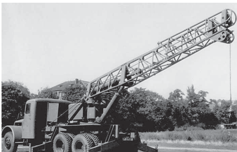
Figur 1.1.8: Mobilkran montert på lastebilchassis med fagverksbom.
